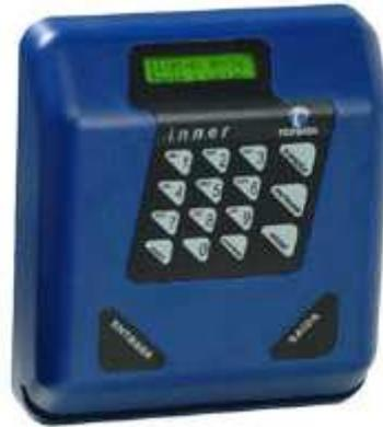
La conexión al PC para la recogida de datos se realiza mediante cable serie RS-232 o RS-485 (con convertor a RS-232) y opcionalmente con un convertor TCPIP mediante cable UTP-Cat5 con conector RJ-45.
