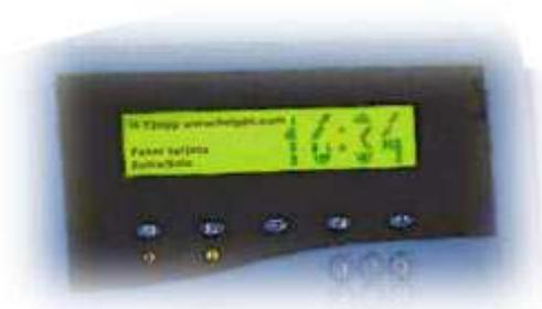
Al pasar la tarjeta el terminal emitirá un pitido y enviará un mensaje al display. Si la tarjeta no es correcta, el mensaje dirá tarjeta incorrecta.
